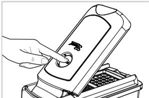
Zur Reinigung des fest integrierten Stifterasters drücken Sie den „Push“-Knopf auf der Oberseite des Schneid-Oberteils. Das integrierte Reinigungsgitter wird automatisch nach unten gedrückt und entfernt selbst kleine Lebensmittelreste aus dem Stifteraster. Dabei sollte der Deckel geöffnet sein. Falls die Selbstreinigung im geschlossenen Zustand ausgeführt wird, darf sich kein Messereinsatz im Rahmen befinden.
