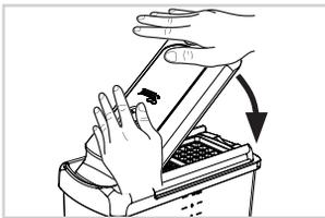
Das Schneid-Oberteil mit beiden Händen schwungvoll in einem Zug herunterdrücken. Das Lebensmittel wird durch die Klingen gedrückt und automatisch im Auffangbehälter aufgefangen.
