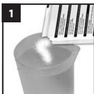
Handelsüblichen Entkalker in einen Behälter mit heißem Wasser geben (ggf. die Anwendungshinweise auf dem verwendeten Entkalker befolgen).
