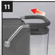
Die Kapsel wird automatisch ausgestoßen, wenn die Kapselaufnahme (H) durch Ziehen des Hebels (I), bis er senkrecht steht, geöffnet wird. Die Kapseln fallen in den Kapselauffangkorb (C).
