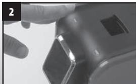
2 Die Steuertaste „Espresso“ (G) 3 Sekunden lang gedrückt halten. Wenn der Finger weggenommen wird, blinkt die Steuertaste (G) schnell und die Pumpe schaltet sich ein. In dieser Phase befindet sich die Maschine im Programmiermodus (die Maschine gibt Espresso aus). Wird die Steuertaste „Espresso“ (G) hingegen 6 Sekunden lang gedrückt gehalten, wird die Einstellung für den Espresso wieder auf die Werkseinstellungen (25 Sekunden) zurückgesetzt.
