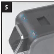
Eine der beiden Touch-Steuertasten (F oder G) berühren: Beide Steuertasten beginnen zu blinken. Wenn das Gerät zur Espressoausgabe bereit ist, hören die Steuertasten auf zu blinken und leuchten dauerhaft auf.
